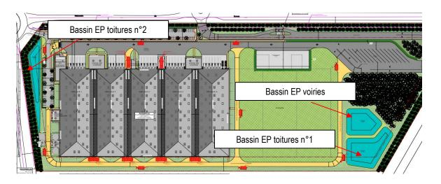
Les eaux pluviales des voiries transiteront par un bassin étanche avant d'être traitées par un séparateur d'hydrocarbures et d'être rejetées dans un bassin d'infiltration. Le bassin étanche servira de bassin tampon, son débit de fuite sera limité à 5 l/s.
